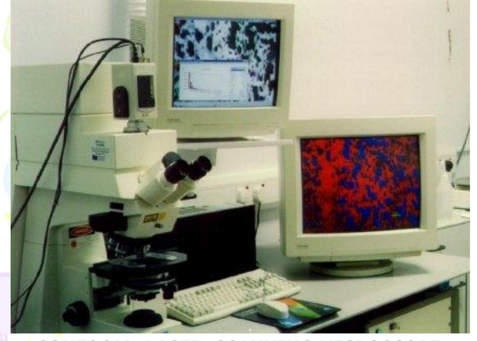
CONFOCAL LASER SCANNING MICROSCOPE
